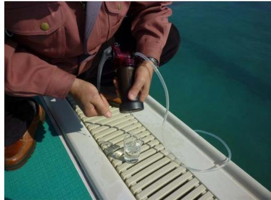
写真 14 簡易浄水器を使ってコップに清浄水を貯めているところ
