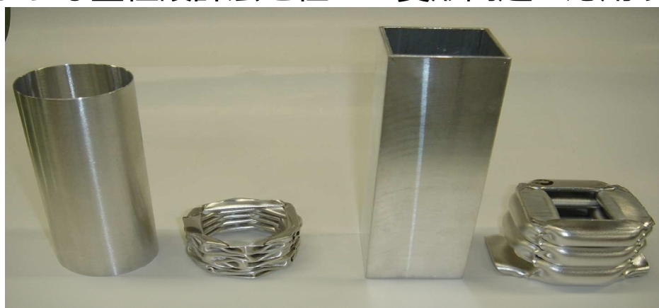
左は円筒,右は角筒の軸圧壊による座屈前後の様子
