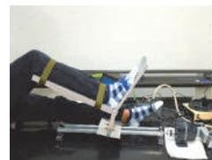
人が膝を屈曲伸展させるときの特性を計測し、その特性に合わせてリハビリを行える機器を開発しています。
