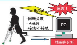
ロボットや産業機械など, 自動機械で使われるセンサやモータなどの技術を, 福祉機器に適用しています. 具体的には, 松葉杖使用者の歩行方法を**手軽な装置**で計測し, 歩き方が不適切な人には**自動でアドバイス**する装置について研究しています.
