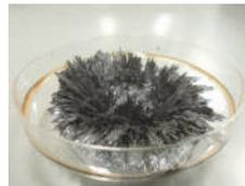
機能性流体とは磁石を近づけたり, コイルに電流を流して磁界を変えるなどにより, 簡単に性質が変わる流体のことです。上の図は磁気粘性流体で, 磁界によって粘度(ドロドロ度)が変わります。左の図はシミュレーションの結果です。この流体の粘度を実験と計算の両方から説明します。
