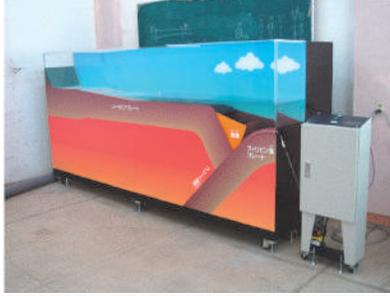
上の写真は、平成25年度から本校に導入された防災教育用の津波発生装置です。プレートの動きによって地震が発生し、その後津波が発生するというメカニズムを視覚的に理解するのに役立ちます。このような実験装置を用いて地震・津波のメカニズムを理解する防災教育を支援します。
