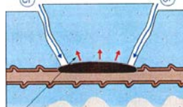
鉄筋腐食によるかぶりの剥落
