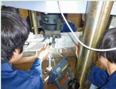
鉄筋コンクリートはりの曲げ試験： 上から荷重をかけたときの変形量の測定の様子
