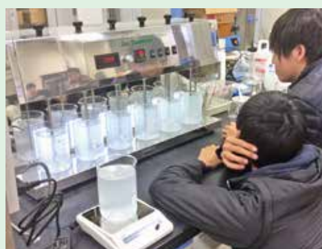
凝集沈殿作用を利用した水質浄化実験
