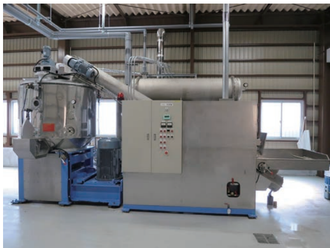
真空乾燥による魚粉製造装置（脱臭装置は右側背面にあり。丸長水産魚粉製造工場で撮影）
