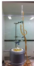
水蒸気蒸留装置により精油を抽出
