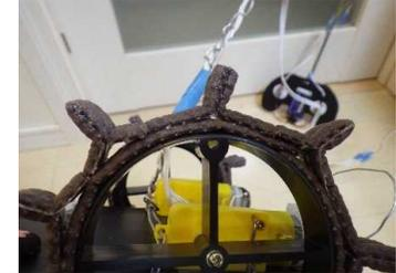
丸い形の建築資材をホイールにし、滑り止めマットを切つてタイヤを作成。
