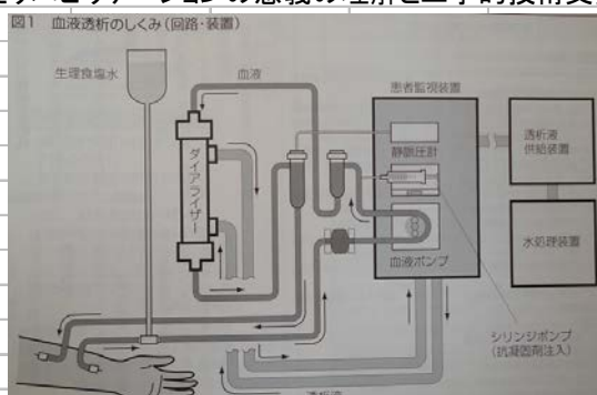
図4 人口透析装置の仕組み
