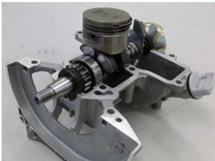
HONDAの4サイクル33ccエンジンの分解と組立を行いエンジンの仕組みを理解し、主要部品であるピストンやクランク軸のスケッチを行い、ピストンとクランク軸周りの組立図を作成する。
