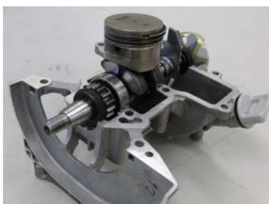
HONDAの4サイクル33ccエンジンの分解と組立を行いエンジンの仕組みを理解し、主要部品であるピストンやクランク軸のスケッチを行い、ピストンとクランク軸周りの組立図を作成する。また、福祉機器で用いられる駆動方法について紹介する。
