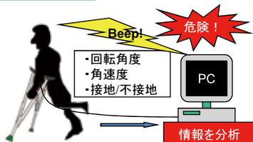
ロボットや産業機械など, 自動機械で使われるセンサやモータなどの技術を, 福祉機器に適用しています。具体的には, 松葉杖使用者の歩行方法を手軽な装置で計測し, 歩き方が不適切な人には自動でアドバイスする装置について研究しています。
