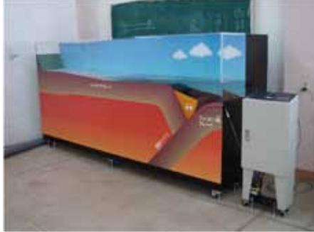
上の写真は、平成25年度から本校に導入された防災教育用の津波発生装置です。プレートの動きによって地震が発生し、その後津波が発生するというメカニズムを視覚的に理解するのに役立ちます。
