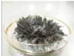
機能性流体とは磁石を近づけたり, コイルに電流を流して磁界を変えるなどにより, 簡単に性質が変わる流体のことです. 上の図は磁気粘性流体で, 磁界によって粘度(ドロドロ度)が変わります. 左の図はシミュレーションの結果です. この流体の粘度を実験と計算の両方から説明します.
