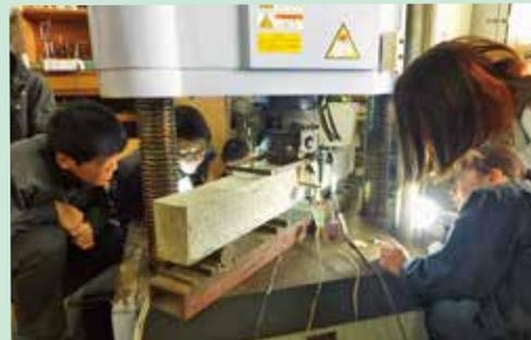
鉄筋コンクリート梁の曲げ試験【建設系】
