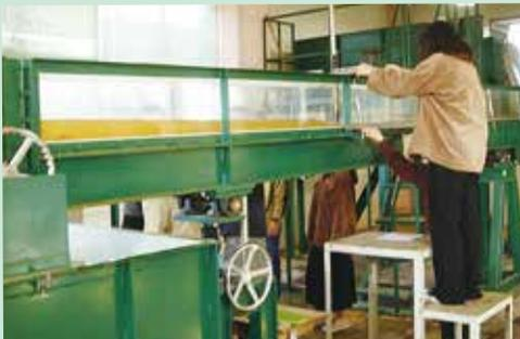
開水路での水理実験における計測【建設系】
