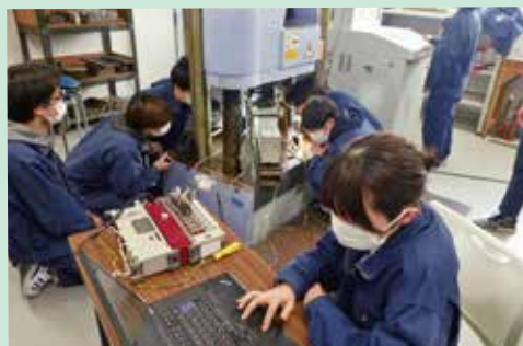
鉄筋コンクリート梁の曲げ試験【建設系】
