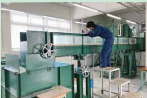
開水路での水理実験における計測【建設系】
