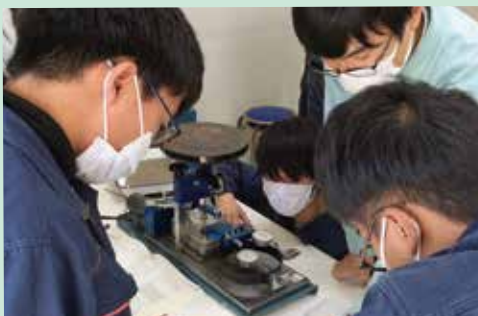
土のせん断強さを調べる試験【建設系】
