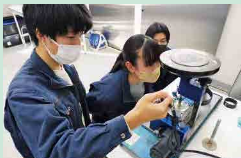
土のせん断強さを調べる試験
