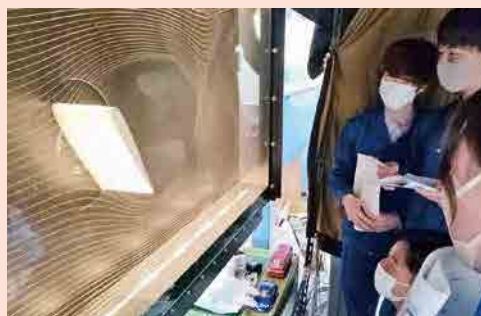
翼まわりの風の流れの風洞解析 <4年生:機械工学実験>
