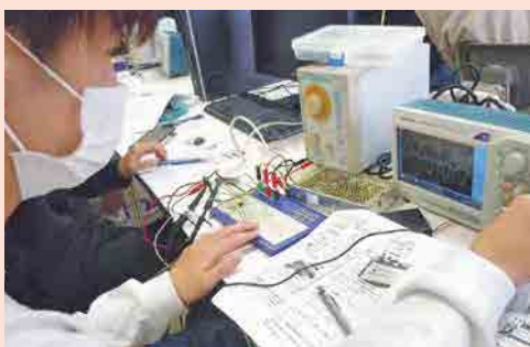
電子回路(OPアンプ)の製作評価実験 <4年生:機械工学実験>
