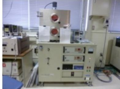
【機器名】薄膜太陽電池作製装置
