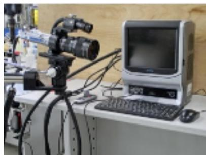
【機器名】生体動作計測実験システム
